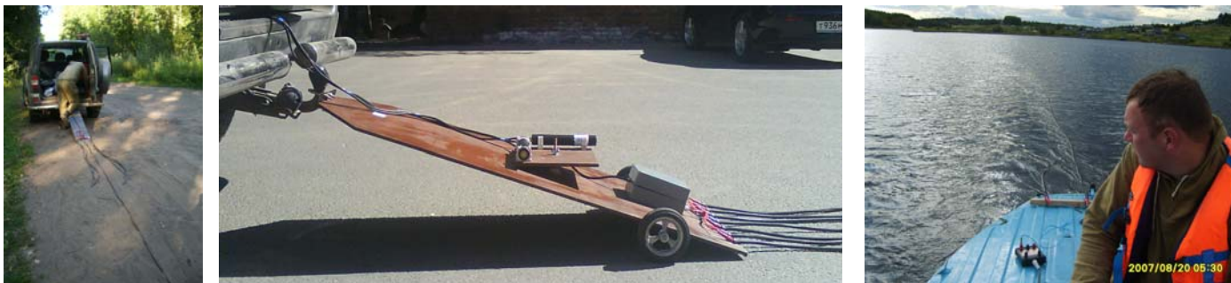
Буксируемое устройство аппаратуры RMT-M с закреплёнными электрической и магнитными антеннами и предусилителем электрического канала (слева). Тестирование лодочного варианта (справа).
